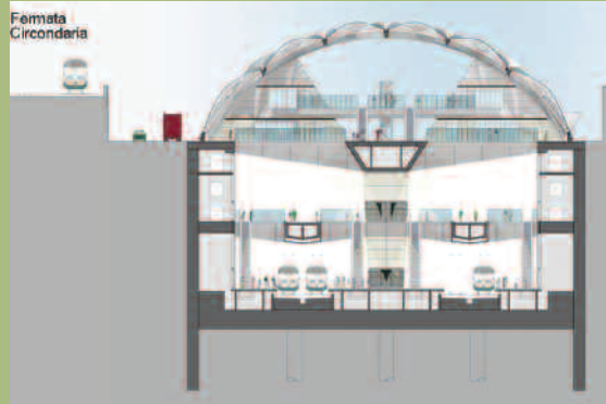
Fig. 10 - Sezione della Nuova Stazione AV di Firenze.
