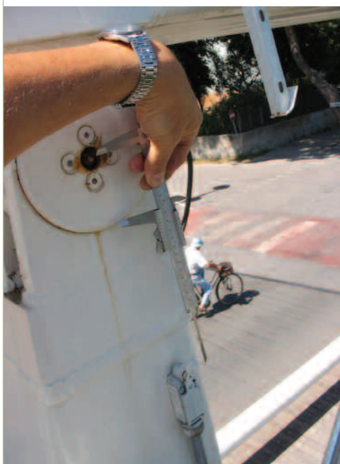
Fig. 5 - Registrazione dei microinteruttori di ponte aperto.
